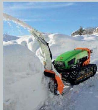
**FRAISE À NEIGE** | La fraise à neige à double étage, actionnée par un moteur hydraulique.
